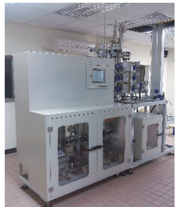
高壓加氫設備
