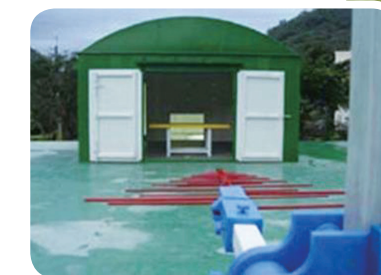
電磁輻射測試之 10 米開放測試場
