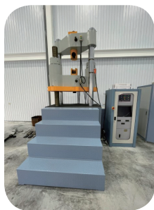
大型扣件檢測設備
