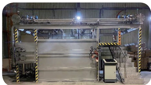
CV流量試驗設備
