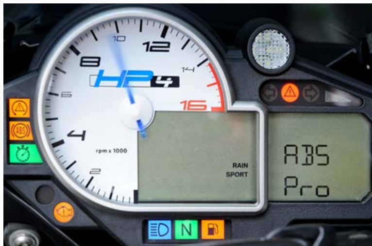
圖一、BMW-Supersport 摩托車系過彎時的防滑煞車系統 (Cornering ABS, 彎道 ABS) 資料來源: MOTO7 網站, BMW 釋出新一代防鎖死煞車系統: ABS Pro, 2014 年 7 月 30 日
