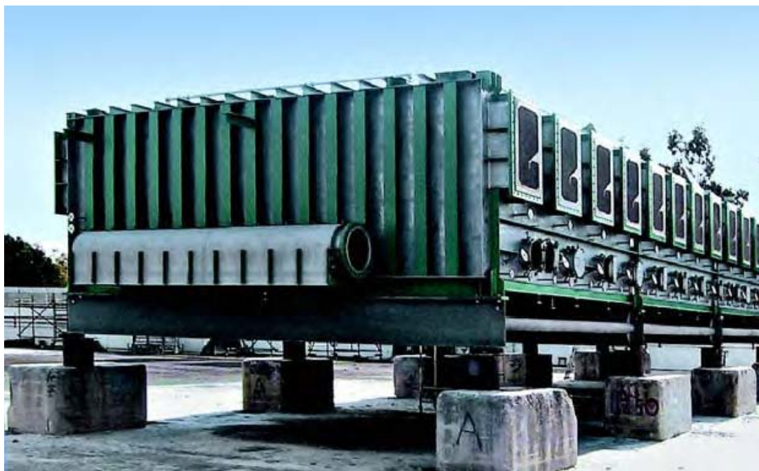
圖 1 用 S32101 與 S32205 雙相不銹鋼製造的海水淡化裝置
