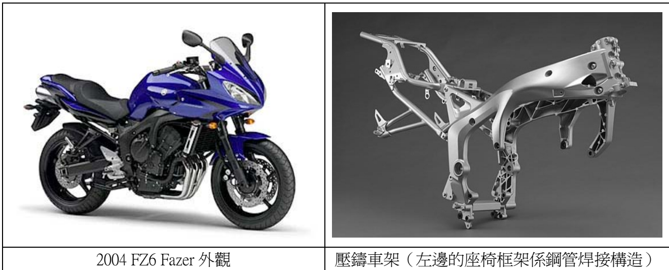
圖 2 YAMAHA FZ6 所使用的鋁壓鑄車架
