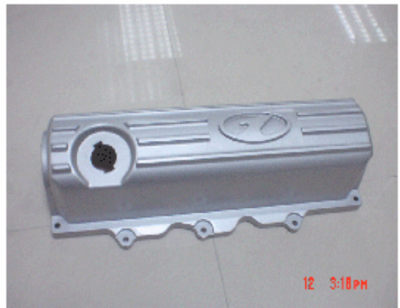
DCC630M 鎂合金壓鑄機、鎂合金氣門罩蓋
