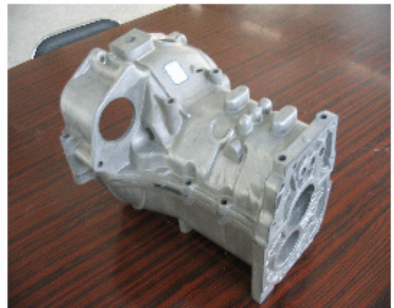
長安集團購進的 DCC800M 鎂合金壓鑄機、東風汽車生產的鎂合金變速箱左右蓋
