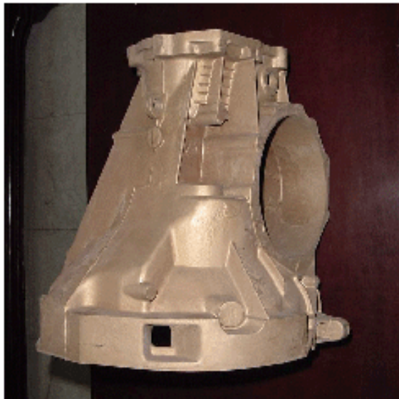
乾通公司生產的鎂合金變速箱、六和公司生產的鎂合金汽車方向盤
