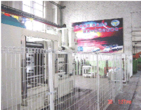
DCC630M 鎂合金壓鑄機、鎂合金氣門罩蓋
